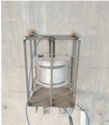
图6 静力水准安装图
