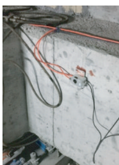
图 5 静力水准仪现场安装图
